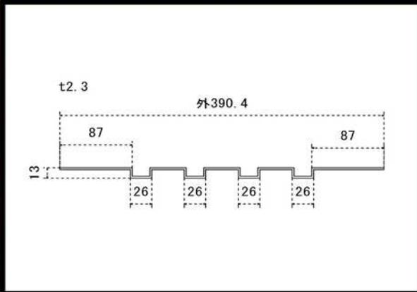
t2.3の連続コの字曲げです。曲げ位置が多く、寸法が出づらい曲げですが、精度良く仕上がっています。地面に置いた時も、ガタつきなく使用できます。
